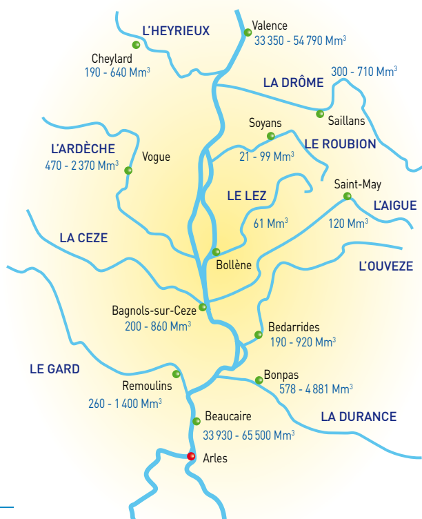
Fig. 1 – Gamme des volumes d'eau annuels 2000-2009 (carte à gauche) et répartition de la médiane en volume des différents affluents (figure ci-dessous).
