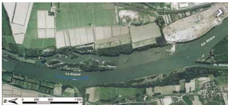
Photo 1 - Casier Saxy. L'ouvrage de grande taille, construit vers 1905 en amont d'Arles, n'est colmaté que partiellement, en raison de la réduction des apports au xx e siècle. Orthophoto 2003 © IGN – PFAR 2000 CRIGE et photo G. Raccasi, Aix-Marseille Université
