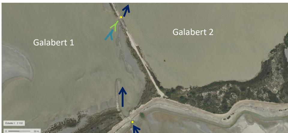
Figure 7 : Plan du dispositif de pêche à l'ouvrage de connexion entre les étangs 1 et 2 du Galabert. Les flèches bleues marines en trait continu indiquent le cheminement pour remonter le système depuis la mer en direction de l'étang du Vaccarès. Le point jaune symbolise le positionnement des sondes d'enregistrement des niveaux d'eau. Le filet DCE est schématisé en bleu clair et le filet à civelles en vert. Photo satellite de Géoportail © IGN
