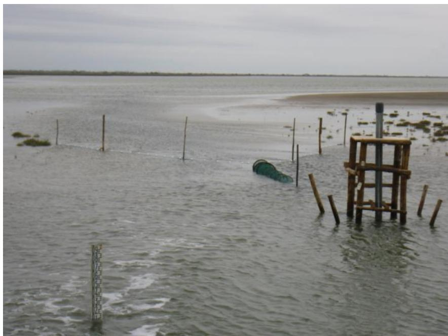
Figure 10 : Photographie du filet DCE posé dans l'étang du Galabert, derrière l'infrastructure de la sonde mesurant le niveau d'eau et la température en continu. Le niveau d'eau permet alors tout juste la connexion du piège. 17/10/2016 © DNS
