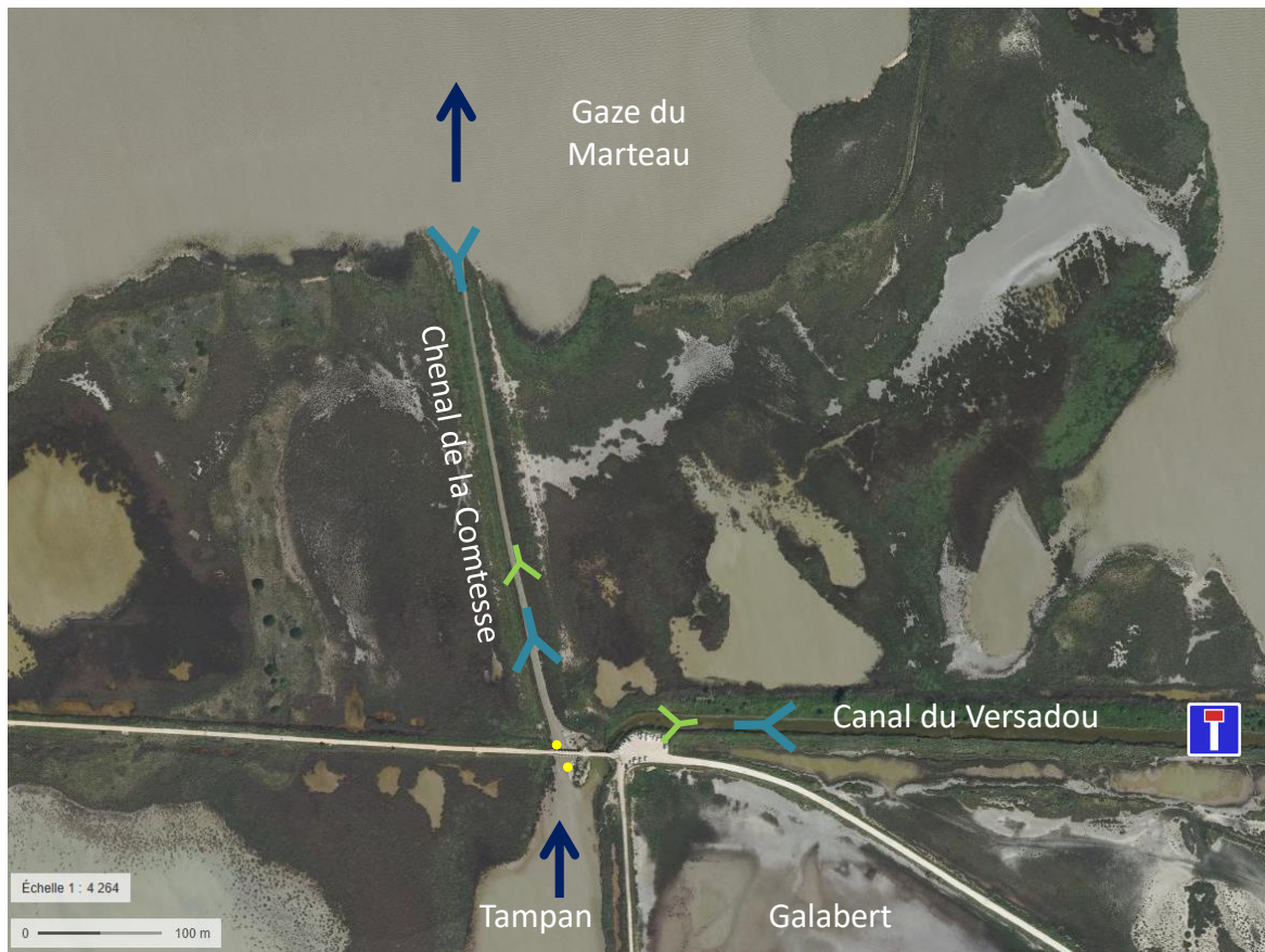
Figure A2-60 : Plan du dispositif de pêche sur le secteur de la Comtesse. Les flèches bleues marines en trait continu indiquent le cheminement pour remonter le système en direction de l'étang du Vaccarès. Les filets DCE sont schématisés en bleu clair et les filets à civelles en vert. Les points jaunes symbolisent le positionnement des sondes d'enregistrement des niveaux d'eau. Photo satellite de Géoportail © IGN 2017
