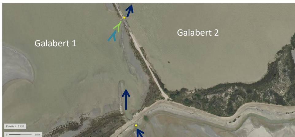
Figure A2-51 : Plan du dispositif de pêche à l'ouvrage de connexion entre les étangs 1 et 2 du Galabert. Les flèches bleues marines en trait continu indiquent le cheminement pour remonter le système depuis la mer en direction de l'étang du Vaccarès. Le point jaune symbolise le positionnement des sondes d'enregistrement des niveaux d'eau. Le filet DCE est schématisé en bleu clair et le filet à civelles en vert. Photo satellite de Géoportail © IGN
