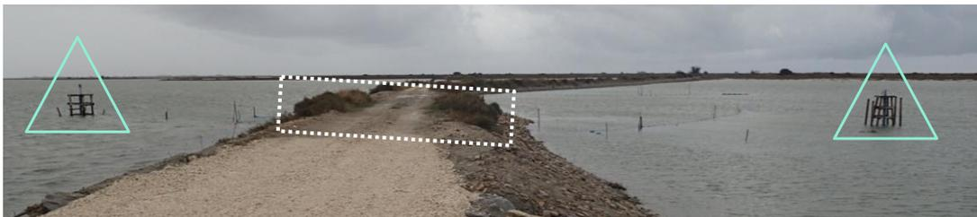
**Figure 4 :** Photographie représentant la position des sondes de mesures de part et d'autre de l'ouvrage de connexion Galabert/Tampan, ici symbolisé par le rectangle en pointillés. Les sondes sont disposées à l'intérieur de tubes PVC solidement amarrés à des structures en bois. 21/10/2019 © D. Nicolas
