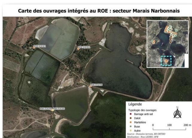
Légende : exemple de cartographie des ouvrages hydrauliques.
